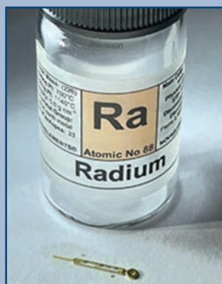
Lancetta radioluminescente di un vecchio orologio contenente radio e rame drogato con solfuro di zinco
