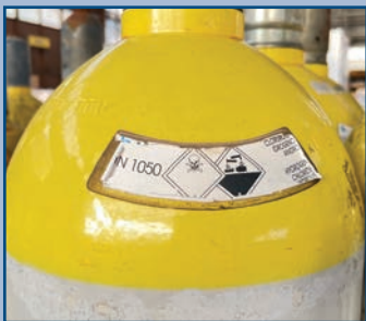
Acido cloridrico anidro (HCl), esempio di gas tossico con pericolo secondario di corrosione.
