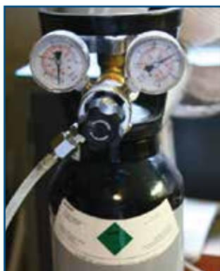
Bombola di azoto compresso.
