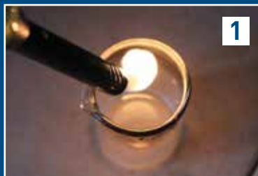
1. Tentativo di innescare la combustione alla temperatura di 0°C cioè sotto il punto di infiammabilità dell'etanolo. I vapori non prendono fuoco.
