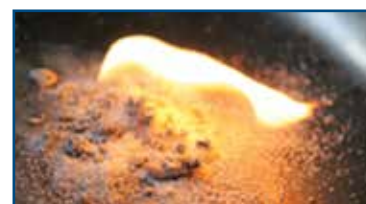
Combustione di un solido infiammabile (Isopropossido di Alluminio).
